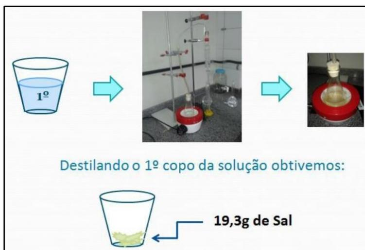
**Figura 4** – Processo de destilação da primeira amostra de mistura coletada
