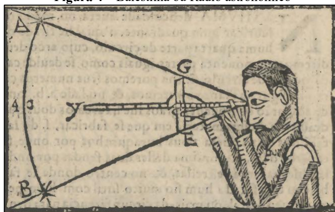
Figura 4 – Balestilha ou Radio astronômico
