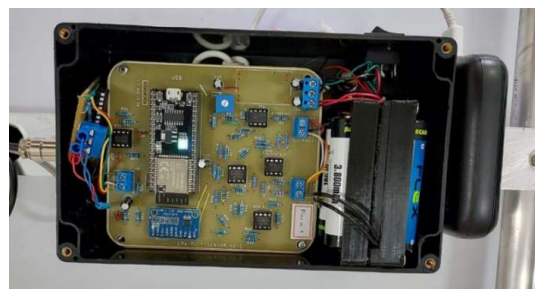
Figura 2. Microcontrolador ESP32-S3 conectado aos circuitos e aos sensores.
