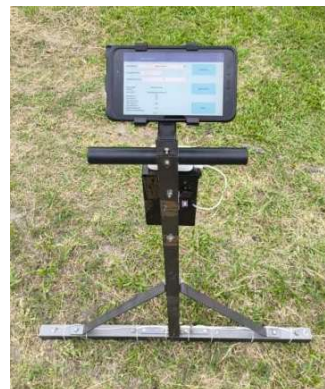
Figura 1. Sistema inteligente com sensores de CEa, de teor de água no solo e de temperatura do solo.
