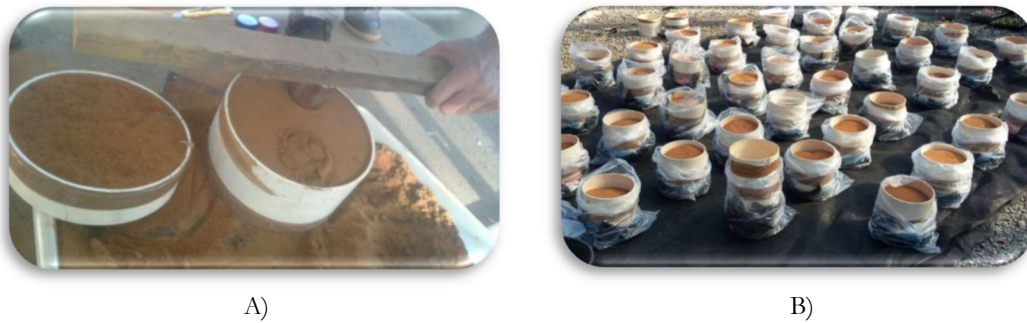
Figura 1. Unidades experimentais constituídas por colunas de PVC de 200 mm. A) Colunas seccionadas, B) Estrutura das colunas. Figure 1. Experimental units consisting of 200 mm PVC columns. A) Sectioned columns, B) Column structure.
