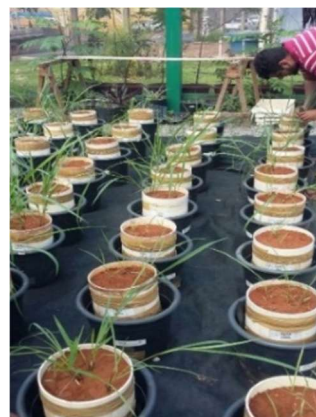
Figura 3. Parcelas experimentais (coluna de PVC de 200 mm).
