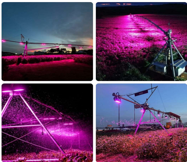
Figura 1. Pivô de irrigação equipado com placas de diodos emissores de luz (LED). Fonte: Grupo Fienile (2023). Figure 1. Irrigation pivot equipped with light-emitting diode (LED) panels. Source: Grupo Fienile (2023).
