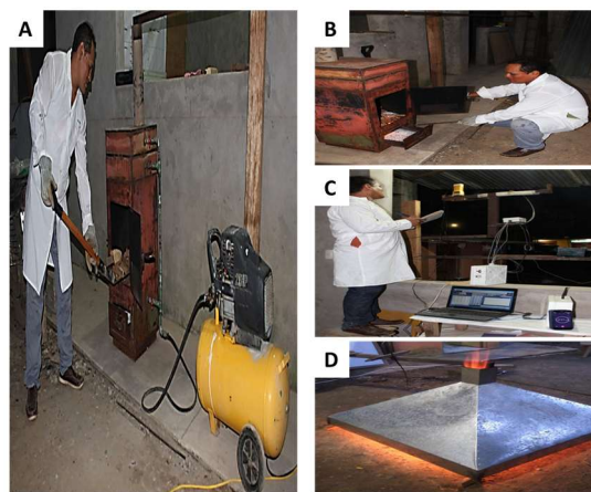
Figura 4. A) Llenado de residuos y ubicación de la compresora de aire. B) Revisando el colector de cenizas. C) Ubicación de los sensores de gases de combustión CO y CO 2 . D) Quemado al aire libre, utilizando la campana colectora.
