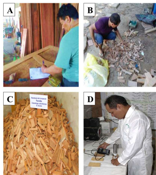
Figura 2. El proceso involucró A) una encuesta a los carpinteros, B) recolección de residuos, C) secado de los residuos bajo cubierta y D) control del contenido de humedad.
