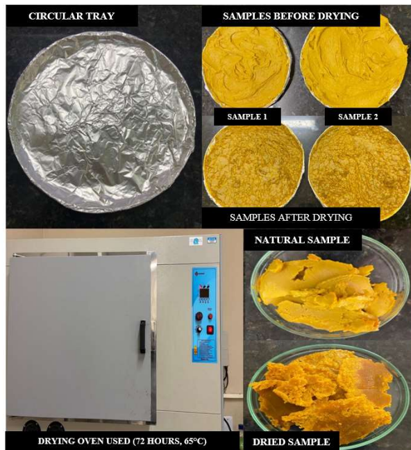
Figure 1. Soybean oil sludge drying process. Figura 1. Processo de secagem da borra de óleo de soja.
