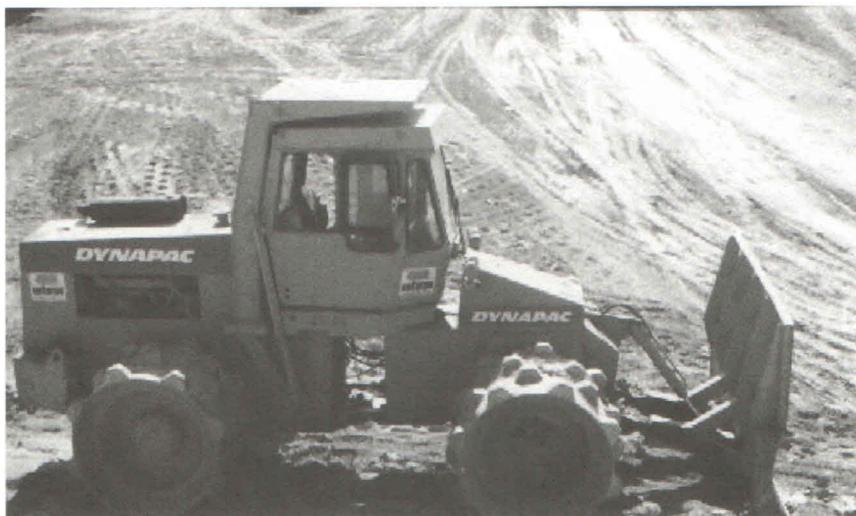
Figura 5 - Tipo de trator compactador utilizado no aterro sanitário de Cuiabá/MT
