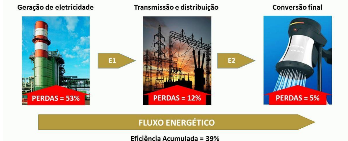
Figura 3: Perdas energéticas acumuladas no aquecimento de água com chuveiro elétrico considerando termelétrica como tecnologia primária de conversão Fonte: Adaptado de (SINDIGÁS, 2012).
