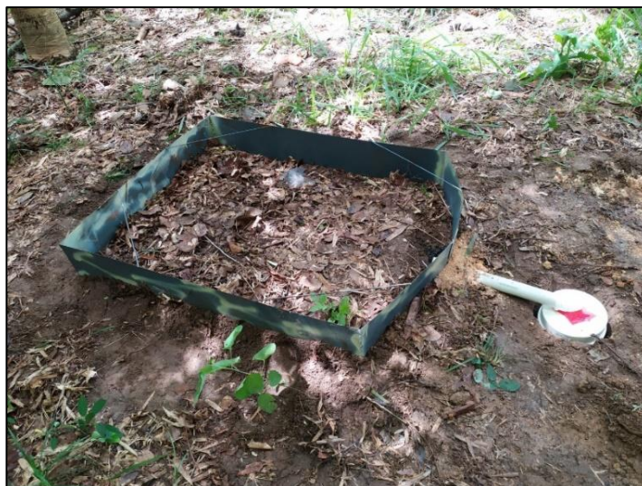
Figura 4 - Calha coletora de água do fluxo superficial.
