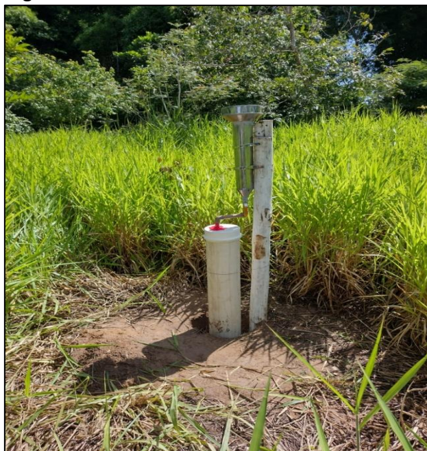
Figura 2 - Pluviômetro com reservatório abaixo.
