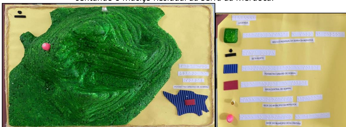
Figura 4. Recurso 5 - Maquete com escala vertical de 1:10.000 e horizontal 1:100.000 representando o Maciço Residual da Serra da Meruoca.
