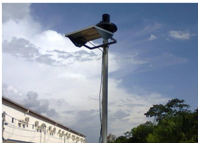
Figura 4. Pluviômetro da estação pluviométrica do Igarapé da Prata. Fonte: Elaborada pelos autores (2020).
