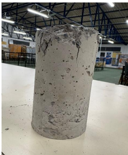
Figura 4 – Concreto com 5% de PET
