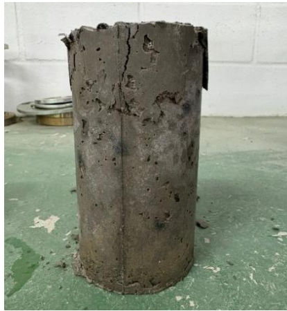
Figura 10 – Concreto com 5% de PET
