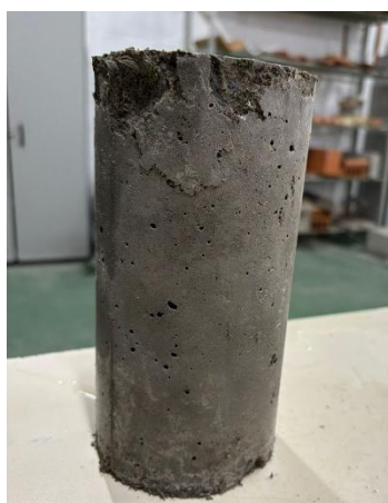
Figura 7 – Concreto com 5% de PET
