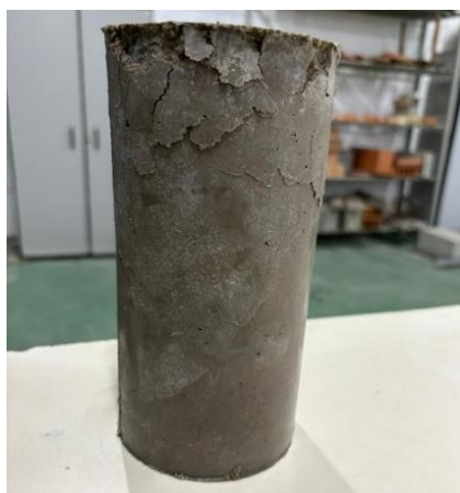
Figura 9 – Concreto com 0% de PET
