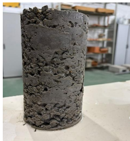
Figura 8 – Concreto com 10% de PET
