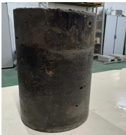
Figura 6 – Concreto com 0% de PET
