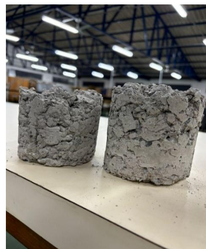
Figura 5 – Concreto com 10% de PET
