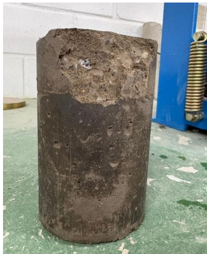
Figura 3 – Concreto com 0% de PET
