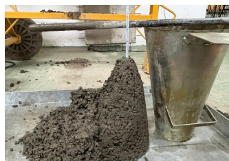
Figura 2 – Abatimento por cisalhamento no concreto com 10% de PET
