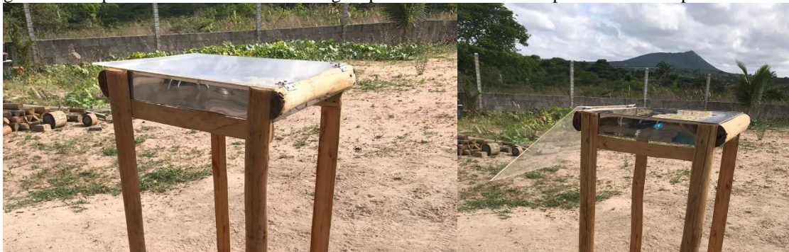
Figura 3 - Tampa articulada a câmara de secagem para entrada de matéria-prima e saída de produto acabado.
