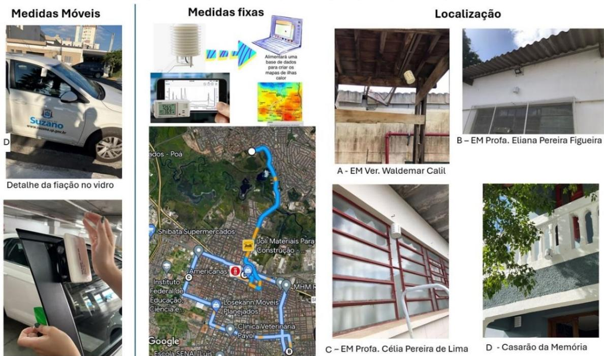
A fim de entender as interações entre as diferentes configurações urbanas e a distribuição do calor e ruído, foi realizado um mapeamento na microescala onde ficou instalado o ponto de medição estática “D”. Foram selecionados 9 pontos de medição numa área de 300×300 metros, onde a temperatura do ar, umidade relativa, temperatura de globo, velocidade do vento, fotos térmicas e nível de pressão sonora a cada 10 min, durante 1h 30 min às 10h da manhã, durante o dia 29 de maio de 2023 (Figura 4).
