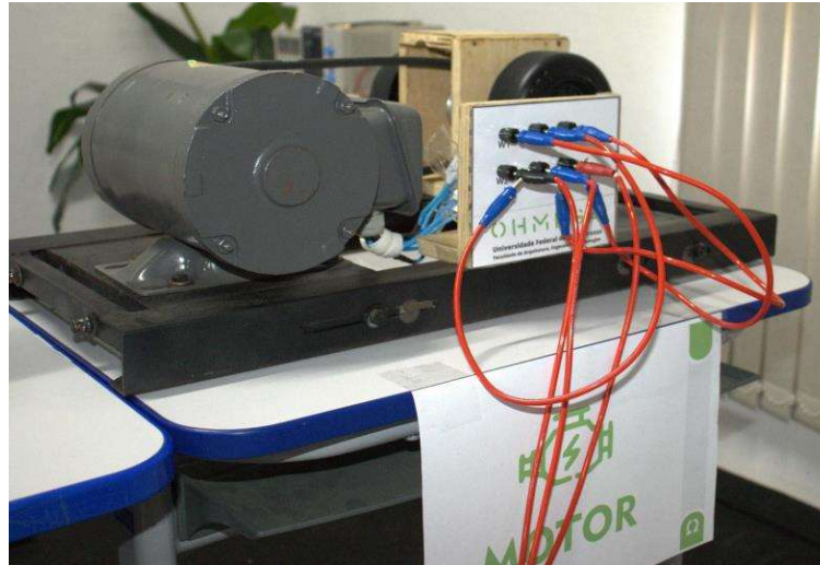
Figura 4 - Motor de indução trifásico elétrico utilizado no experimento que simula o funcionamento de um carro 100% elétrico
