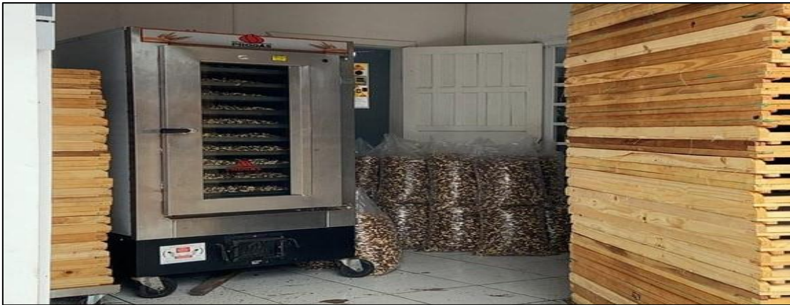
Figura 3 - Forno secador das amêndoas da castanha-do-Brasil. COOPAVAM.
