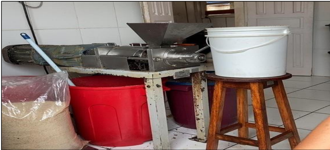
Figura 4 – Máquina de prensagem das amêndoas quebradas para extração do óleo. Resíduo, farinha armazenado em saco plástico e transparente. COOPAVAM.
