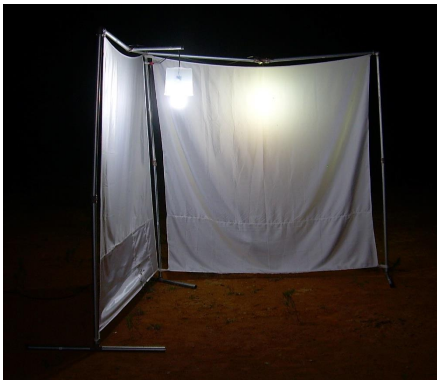
FIGURA 2 - Armadilha luminosa modelo “pano iluminado em L”. Fonte: Teston (2023a).
