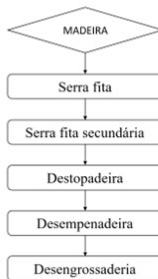
Figura 1. Fluxograma de equipamentos utilizados na confecção dos corpos de prova.
